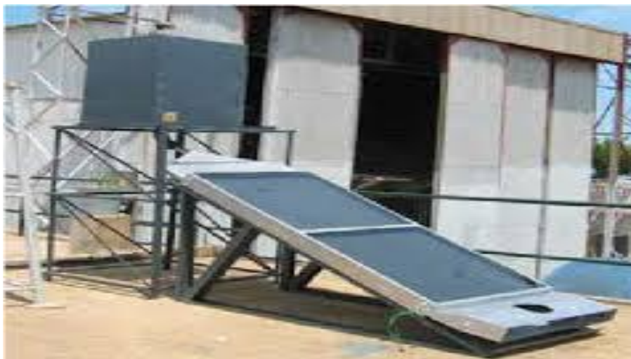
Figure 8 Séchoir solaire indirect destiné au séchage des PAM, réalisé au CDER [25]
