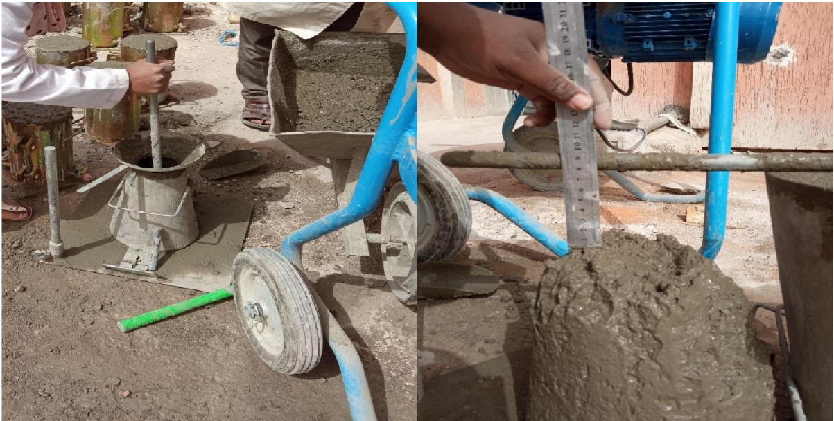
Figure IV. 1- Mise en place et mesure de l'affaissement du béton
