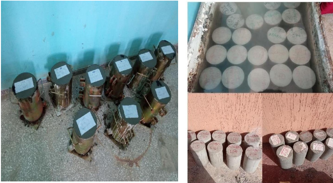
Figure III-12: confection et conservation d'éprouvette.
