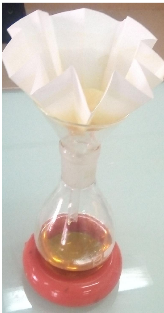
Photo n ° 17: Etape de filtration.
