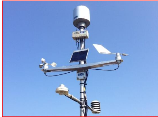
Figure IV.2 : Station météo à transmission GPS- ADRAR
