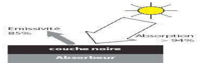
Figure .II.10- peinture noire sur absorbeur [31]
