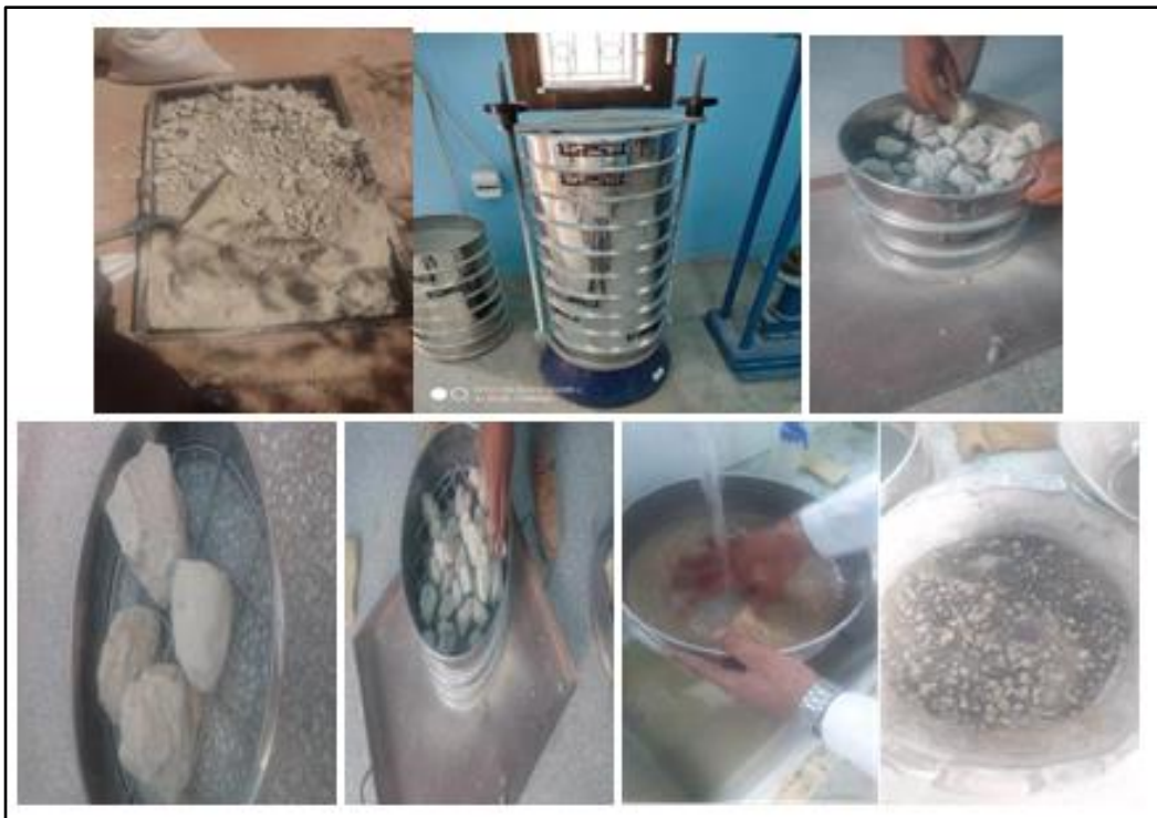
Photo III.5: photos d'exécution de l'essai analyse granulométrique.
