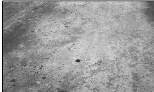
Figure I.8 Accotement réalisé à partir d'un mélange contenant 50% de tuf et 50% de grave 0/50 (Colombier, 1988)
