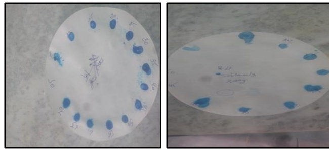
Photo III.10: Résultats de l'essai la valeur de bleu (tuf et sable concassé).
