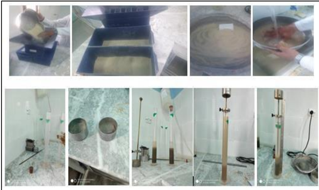
Photo III.8: Mode opératoire de l'essai d'équivalent de sable.
