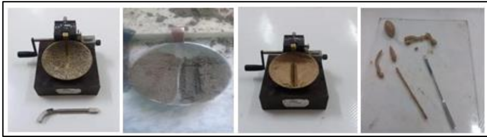
Photo III.7: photos d'exécution l'essai limites d'Atterberg.
