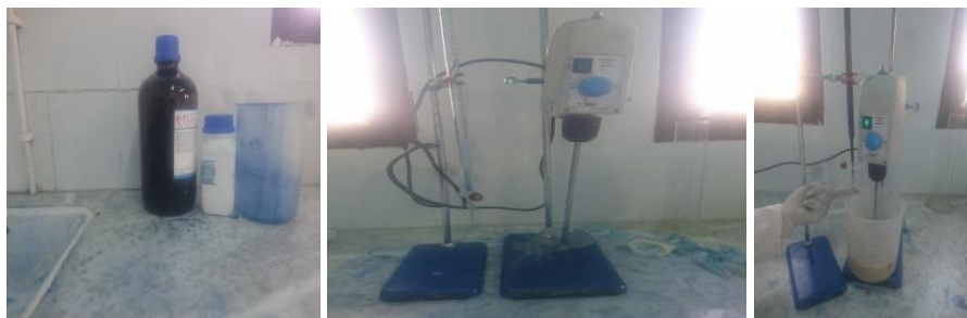
Photo III.9 : Mode opératoire de l'essai bleu de méthylène.
