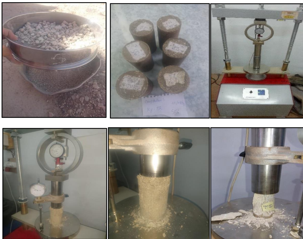
Photo IV.1 Ecrasement des éprouvettes à la compression simple
