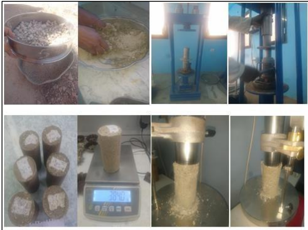
Photo III.13 Mode opératoire de l'essai compression simple.
