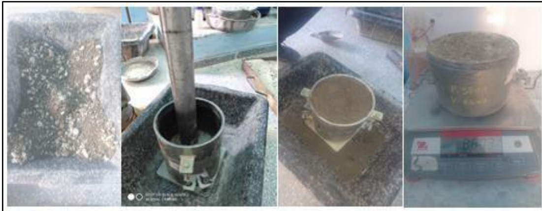
Photo III.11 : Mode opératoire de l'essai Proctor Modifié
