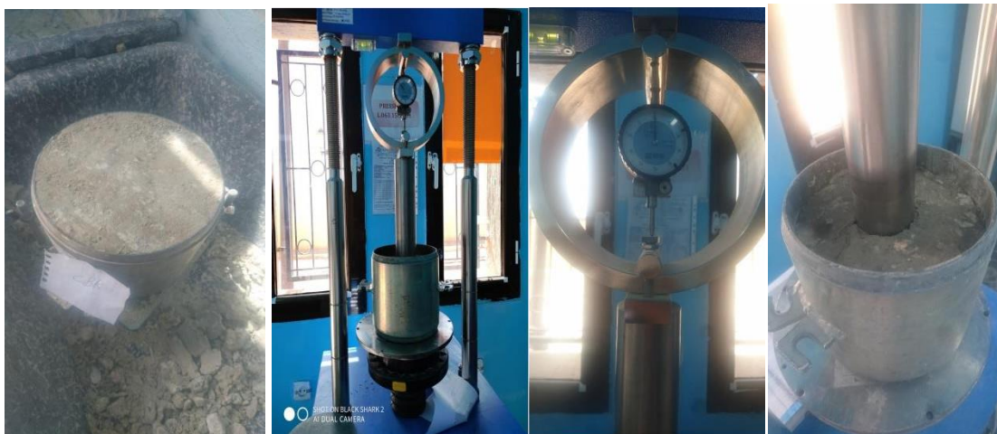
Photo III.12 Mode opératoire de l'essai CBR (L'indice portant immédiat)
