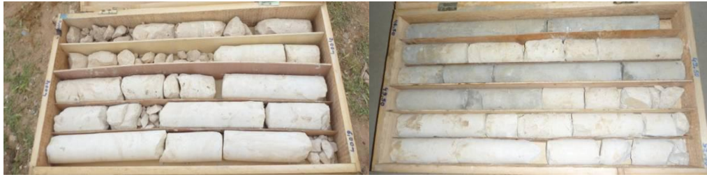
photo II.2: Photographies du sondage S-208. Détail des calcaires compacts du groupe géotechnique Cn.
