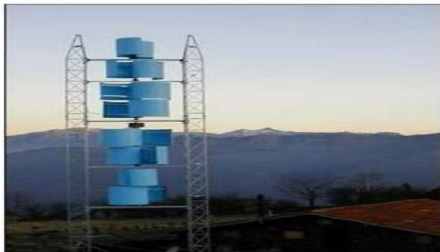
الشكل 8.I. مولد الرياح ذو المحور الرأسي (هيكل سافونيوس)
