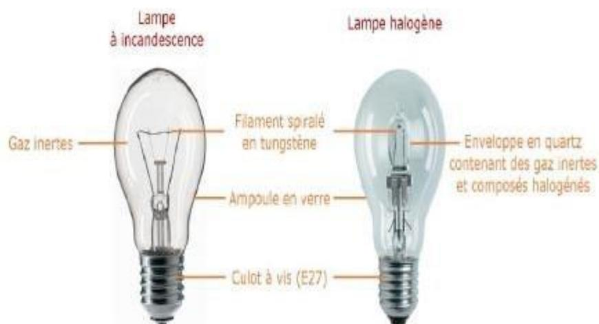
fig 2.8 : lampe à incandescence halogéné
