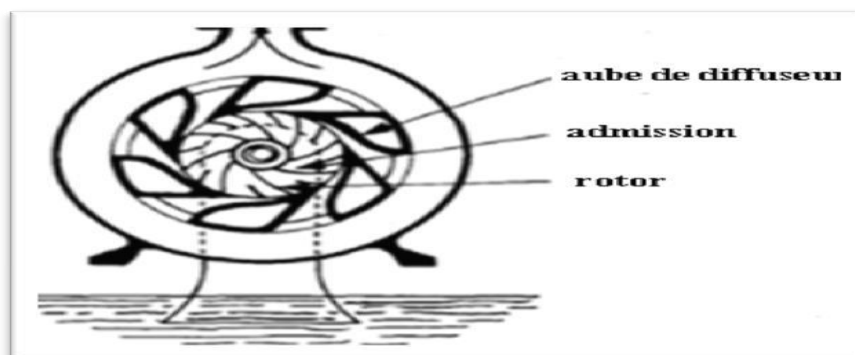
Figure I.16 : Illustration d'une centrifuge à turbine [42].
