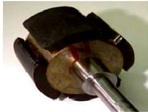
b).Rotor à poles saillants
