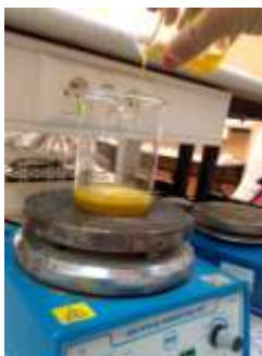
Figure IV.15: Photo présent l'ajout la phase huileuse dans la phase aqueuse.
