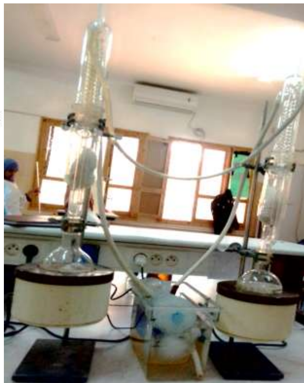
Figure IV.2 : Appareil Soxhlet (capacité 250 ml)
