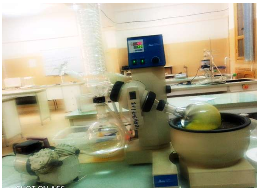
Figure IV.6 : Photo démonstrative de l'opération de récupération d'huile de grains de millet
