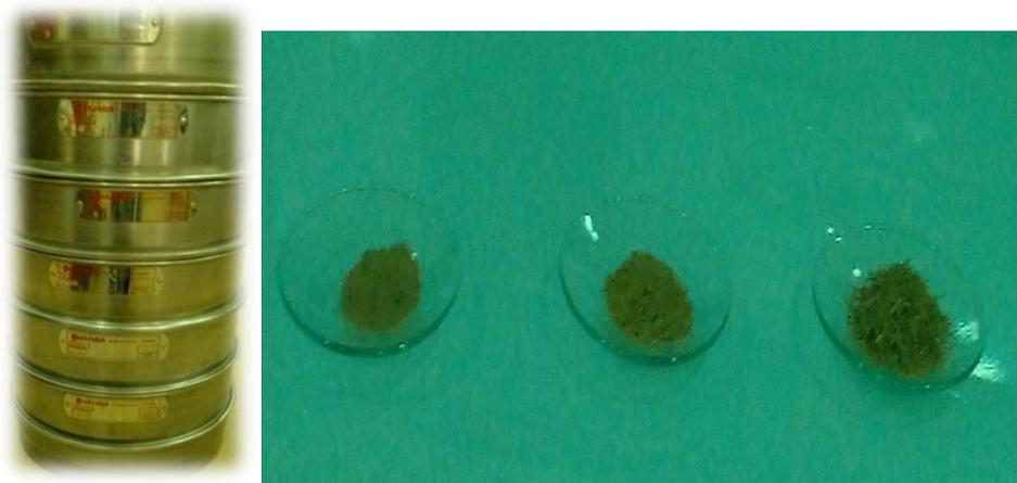
Photo III.4 : La machine de tamisage et de grains
