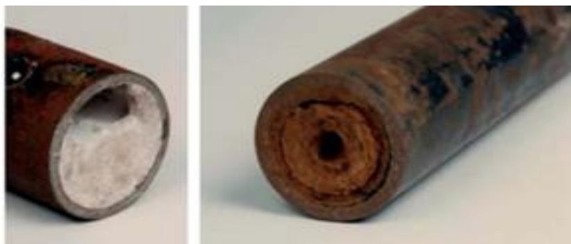
Figure II.6: Exemple de tartre dans un tuyau (Manuel, 2010).
