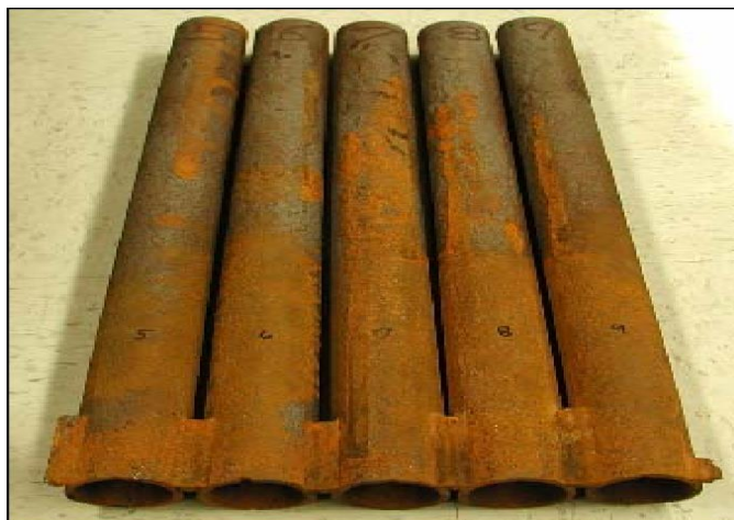
Figure II.7: Exemple de corrosion dans un tuyau (Duvivier, 2006).
