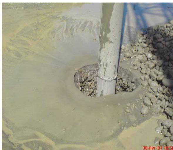
**Figier II.5:** Phénomène de liquéfaction local (*Site : barrage Kissir- Jijel*)
