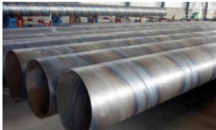
**Photo 04 II:** les tubes soudés sous la forme en spirale
