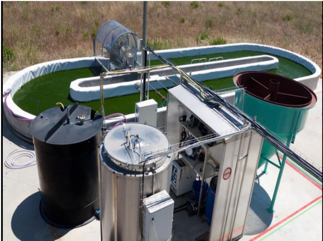
Figure .I.9: Système de production ouvert de type Raceway (Sialve B.1, Steyer J-P. 1.,2013)
