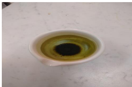
Figure.III.7: biodiesel produits par la transestérification directe après évaporation des solvants et H 2 O
