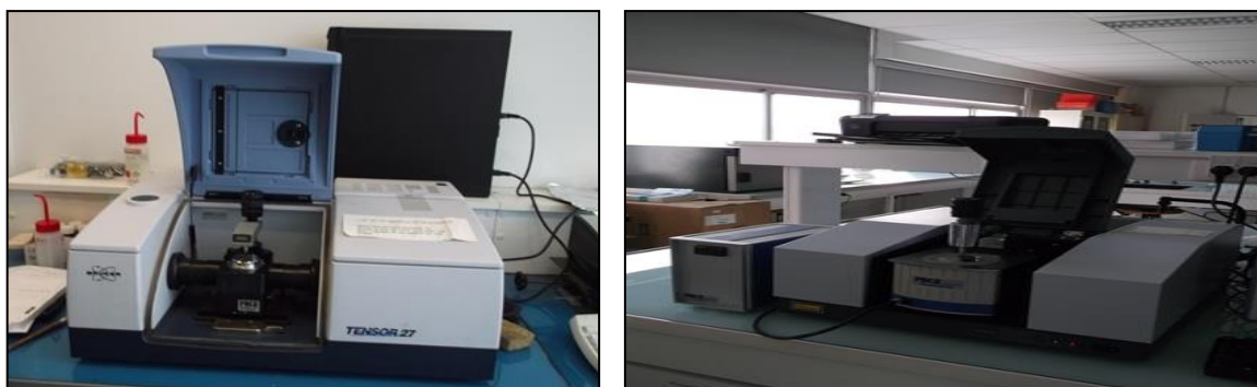
Figure. II.9: Spectroscopie Infrarouge BRUKER Tensor 27 avec module ATR PIKE Miracle SHIMADZU IR Affinity avec module ATR PIKE Gladiatre.
