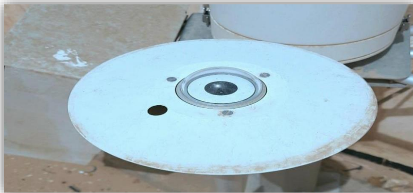
Fig.III.1 : Pyranomètre pour la mesure du rayonnement global.
