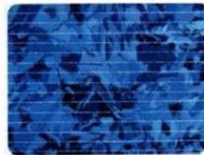
Fig.I.10 Cellule au Silicium poly-cristallin [30]
