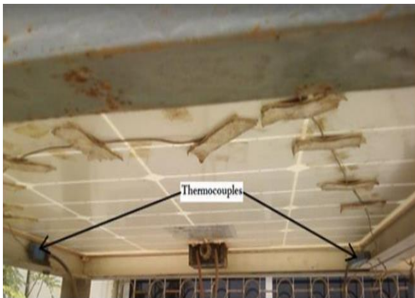
Fig.III.2 Thermocouples sur la face arrière du module [27].
