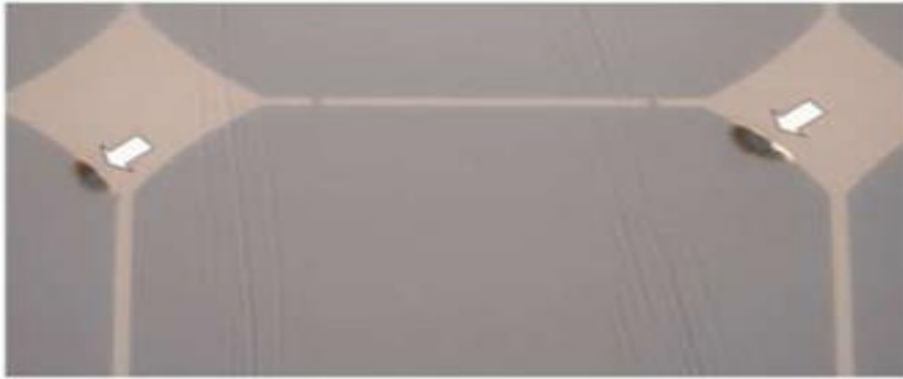
Figure (II-21) : Dégradation du module PV par des points chauds sur les bords des coins supérieurs
