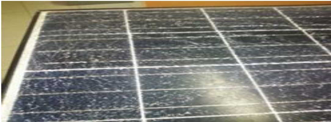
Figure (II-19) : Module PV présentant des bris de verre
