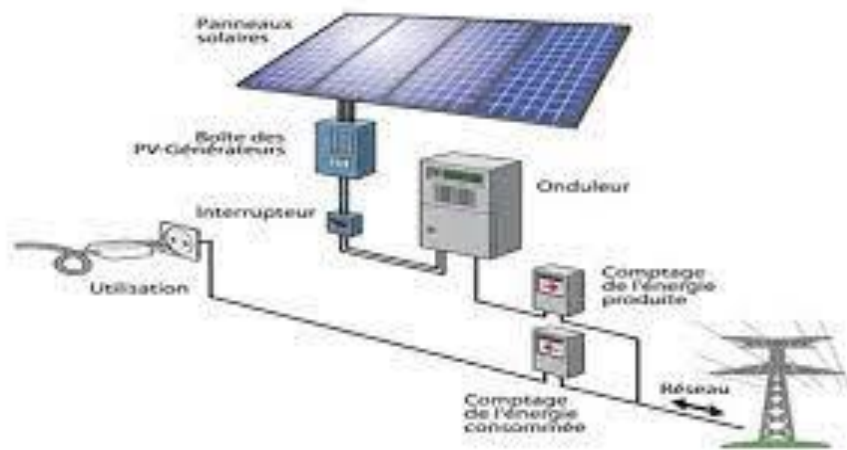
Figure(II-5) : Le comptage d'énergie produite de système PV
