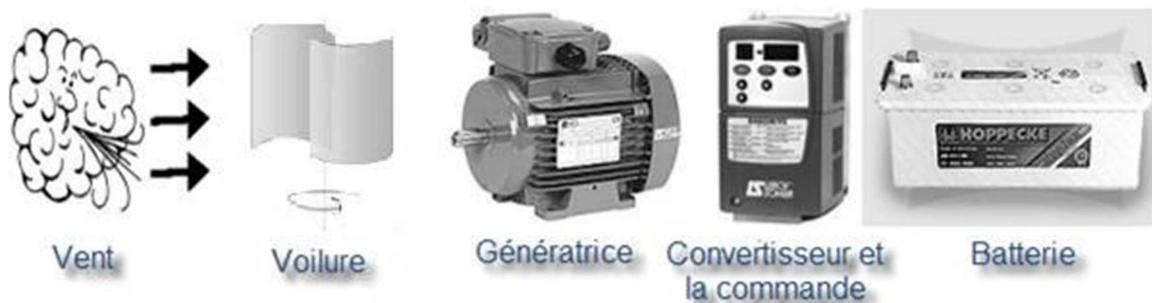
**Figure 4.1** : La chaîne de conversion d'énergie au niveau de l'aérogénérateur[32].
