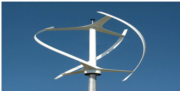
**Figure 1.2:** éolienne a axe verticale [7]
