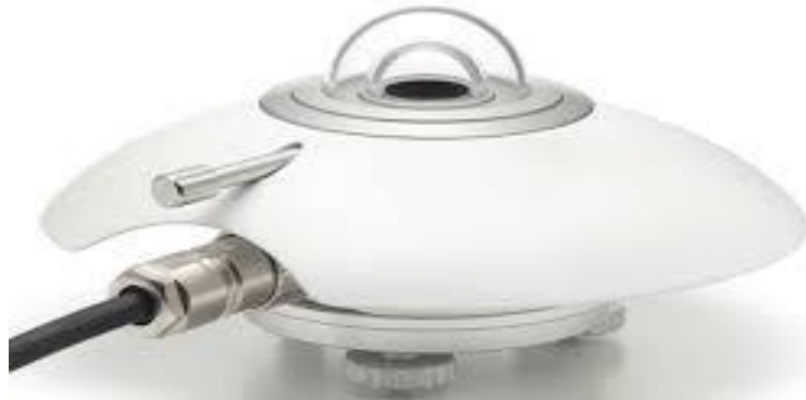
Annexe I : Le pyranomètre
