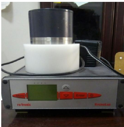
Figure III.6 : Appareil Hygrolab (l'activité d'eau)
