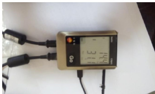
Figure III.5: Appareil thermo et hygromètre Testo H176
