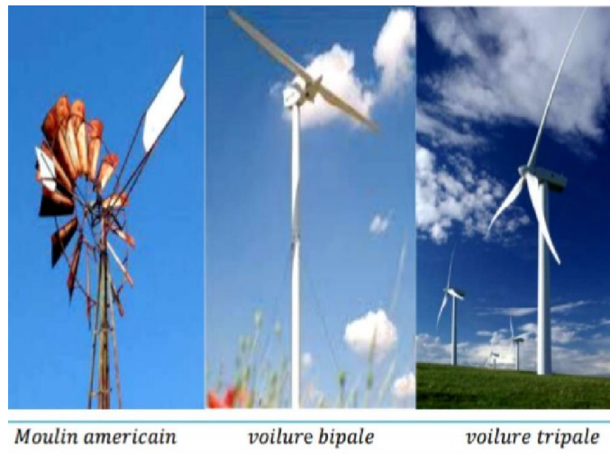
Figure I.10: Technologie éolienne à axe horizontal [42]
