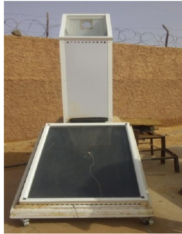
Figure II.5 : Le séchoir solaire mixte à l'URERMS Adrar
