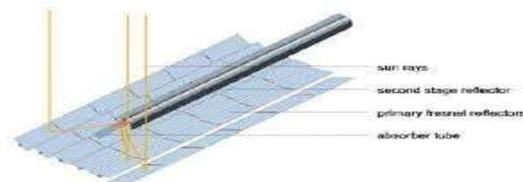
Figure 9: Principe de fonctionnement des miroirs de Fresnel[e]
