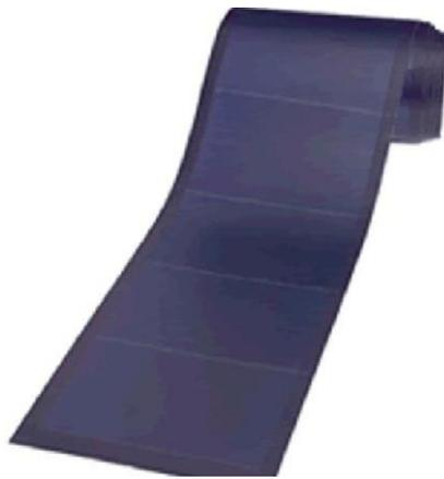
**Figure (II-7) :** Module photovoltaïque souple au silicium amorphe  $\alpha$ Si triple jonction pour une efficacité de 6,5% (photo Unisolar)
