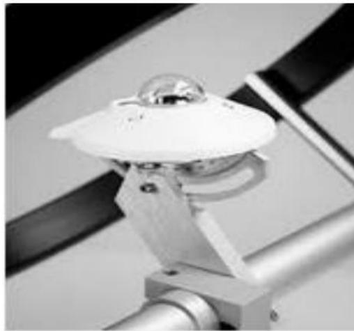
**Figure (I-11) : Pyranomètre**
