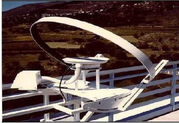
**Figure (I-10) : Pyranomètre avec anneau d'ombrage**
