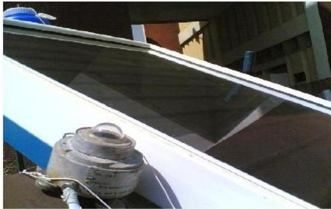
Figure (I-12) : Solarimètre type (Kipp Zonen)
