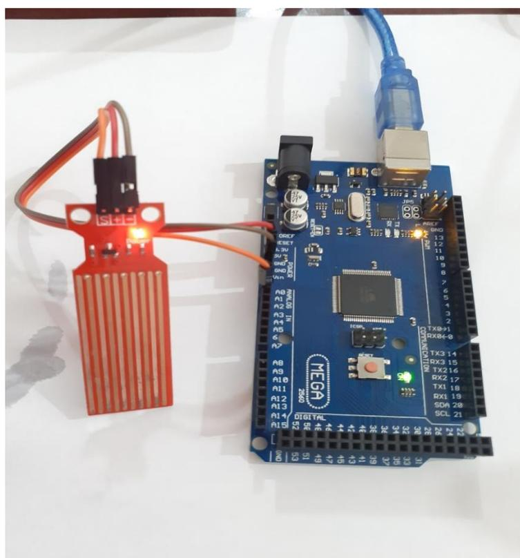
Figure III.10. Schéma de branchement réel du capteur de niveau d'eau.
