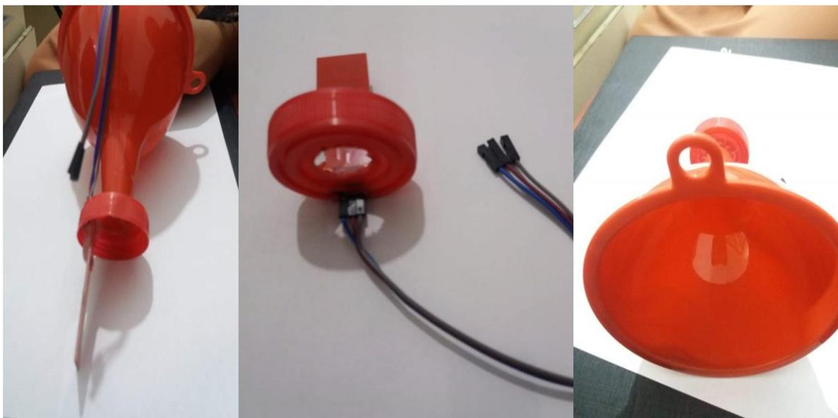
Figure III.11. Étapes de réalisation du pluviomètre.
