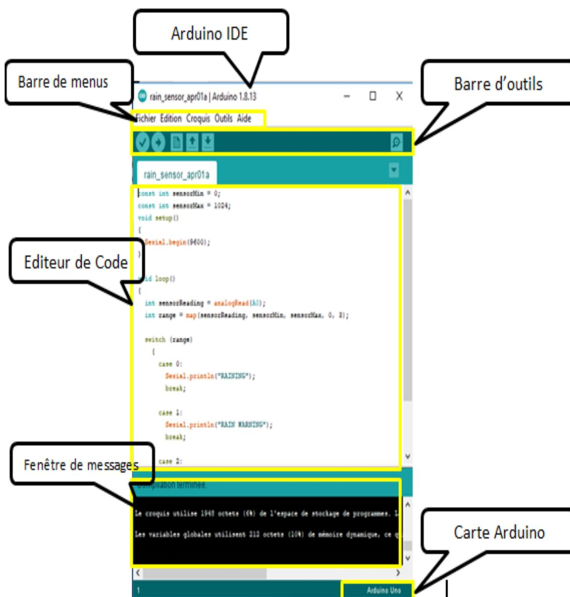
Figure II.15. L'interface de programme Arduino.
