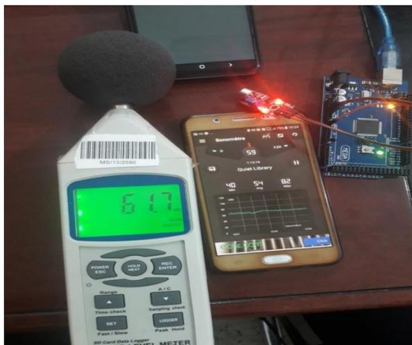
Figure III.32. Étalonnage à l'aide du Décibel mètre.
