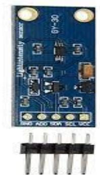
Figure II.7. Capteur de l'intensité lumineuse.
