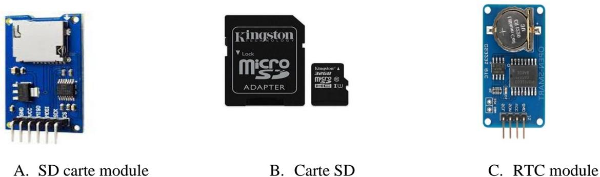
Figure III.34. Outils du système de stockage.
