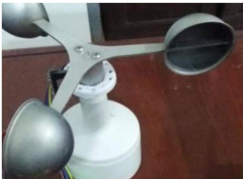
Figure III.22. Anneau préféré et capteur photoélectrique montés sur le corps de l'anémomètre.
