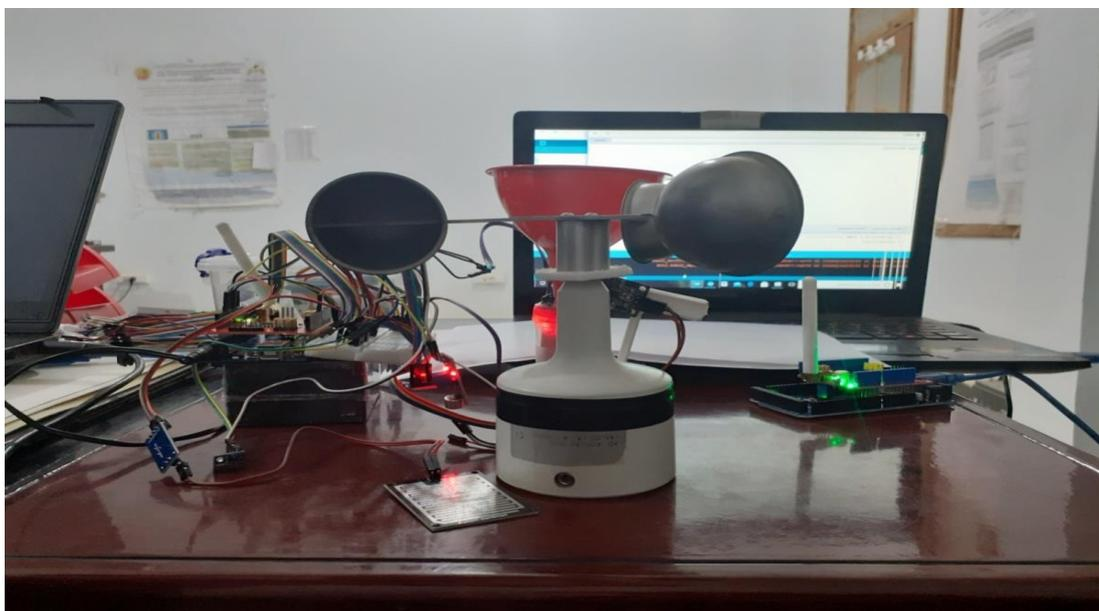
Figure III.52. : Montage et réalisation réel de la station météorologique.
