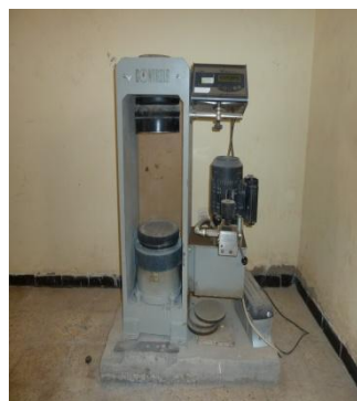
Figure II.11 : Appareillage de l'essai d'écrasement
