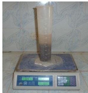
Figure II.8 : Eprouvette pour la masse volumique
