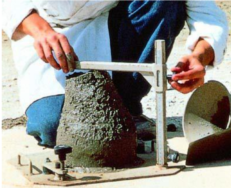
Figure I.3 : Mesure de l'affaissement.
