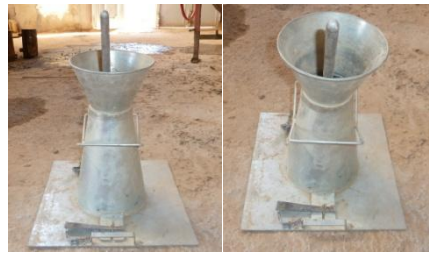
Figure II.9 : Appareillage cône d'Abrams.
