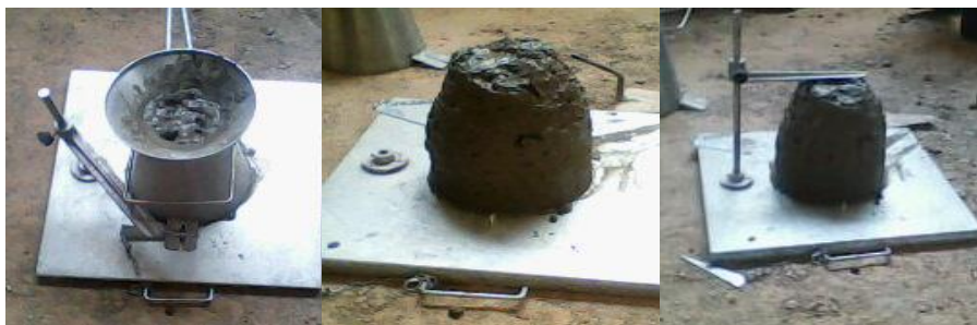
Figure II.10 : Essai d'affaissement au cône d'Abrams
