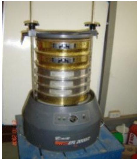
Figure I.11:Table vibrante et les tamis (essais de granulométrie).
