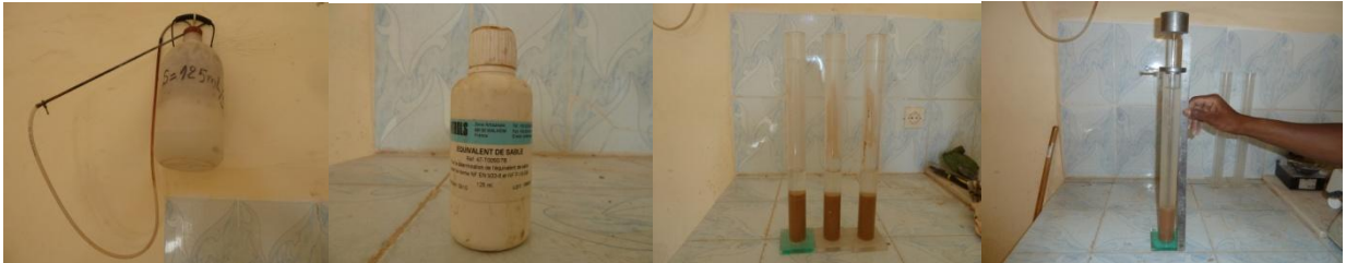
Figure II.5 Les Etapes de mesure les hauteurs de L'essai équivalent de sable.
