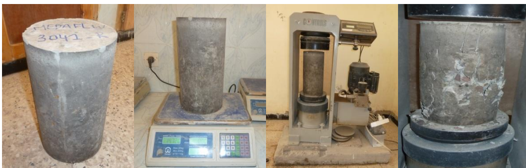
Figure II.13 : Etape d'écrasement du béton.
