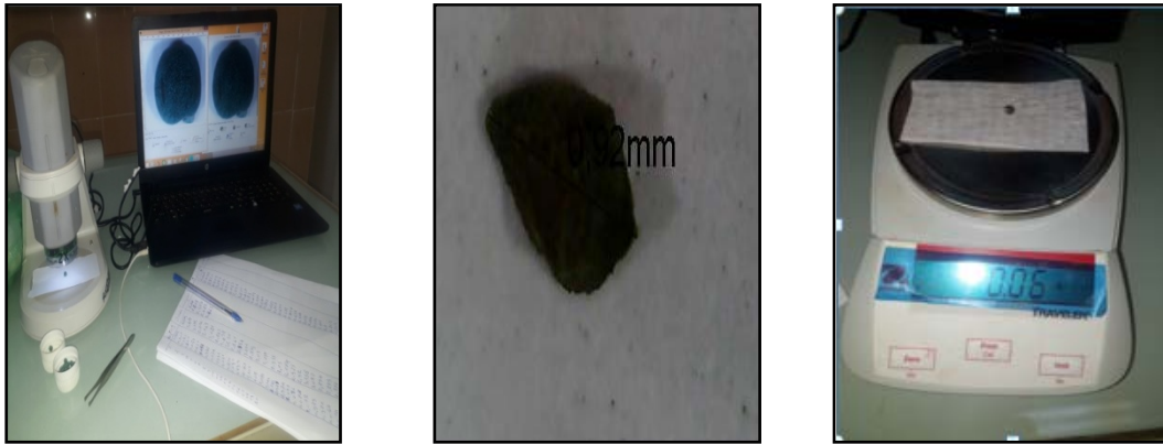
Figure 17 : Mesure de la longueur par une loupe numérique et le poids par une balance
