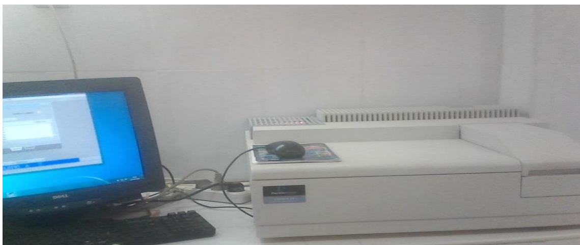
Figure 26. Le dispositif UV visible est utilisé pour mesurer les solutions de colorées.
