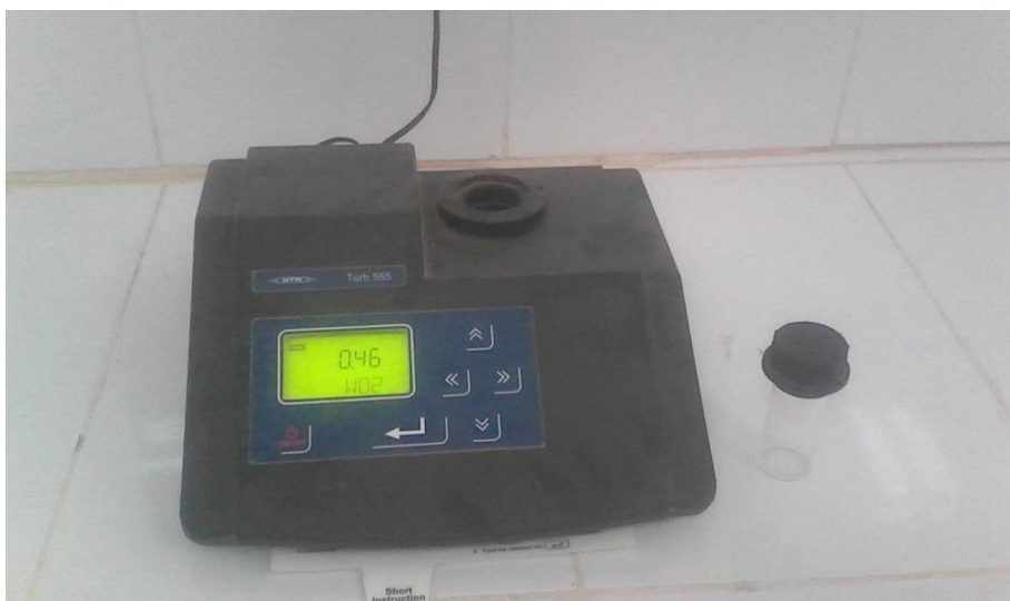
Figure 28. Mesure de la turbidité par un turbidimètre
