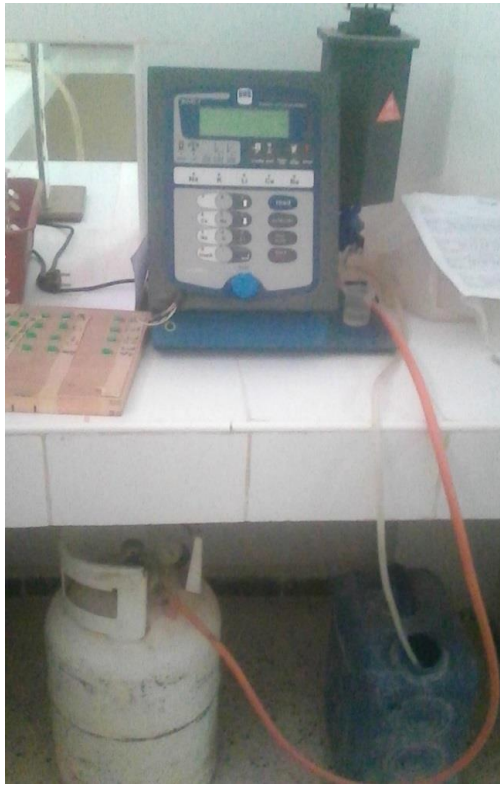
Figure 23. Photomètre de la torche Figure 24. La mesure de Na et K utilisant le photomètre à flamme
