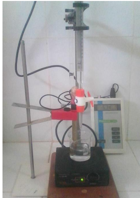
Figure 19. Titration par H_2SO_4 et mesure du pH
