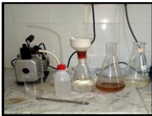
Fig. IV .14 : filtration avec pompe à vide
