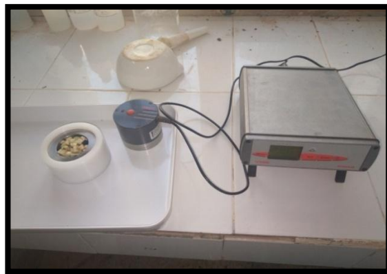
Fig. IV .22 : Mesure de l'activité' d'eau
