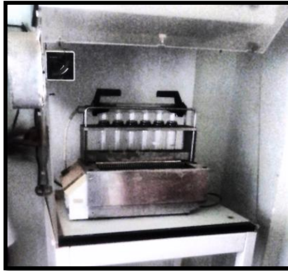
Fig. IV .20 : appareil de minéralisation
