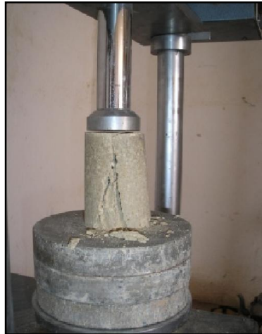
Photo. III. 18: Ecrasement des éprouvettes à la compression simple après conservation
