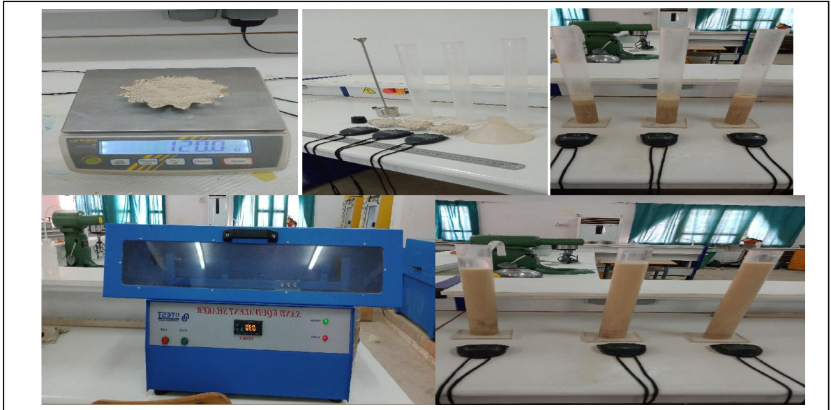
Photo. III. 8: Mode opératoire de l'essai Equivalent de sable
