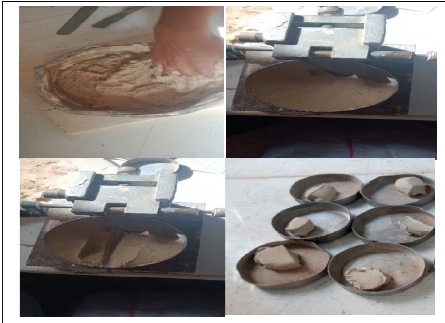
Photo. III. 6. : Etapes de l'essai de limite de liquidité
