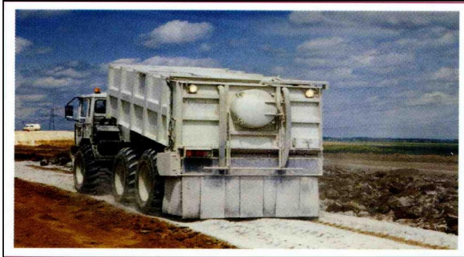
Figure II.5 : Epandeur moderne équipé d'un dispositif de variation de la largeur d'épandage (GTS, 2000).
