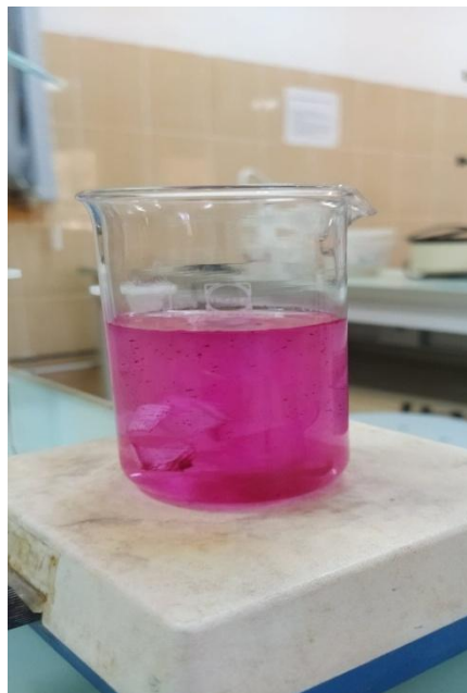
Figure IV.4 : Les membranes mises en contact sous agitation avec la solution du colorant.
