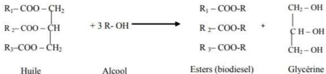
Figure 6 : La réaction de transestérification de l'huile en biodiesel (Alloune, 2012).
