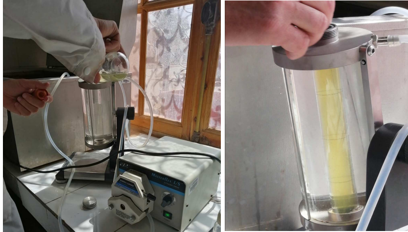
Figure27: Détermination de la viscosité à l'aide d'un Viscosimètre à bille.
