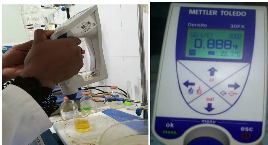
Figure29 : Mesure du densimètre à l'aide de densimètre
