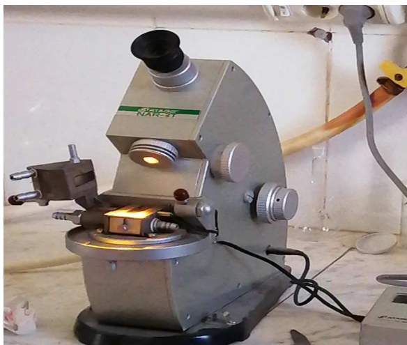
Figure28: Mesure de l'indice de réfraction à l'aide d'un réfractomètre
