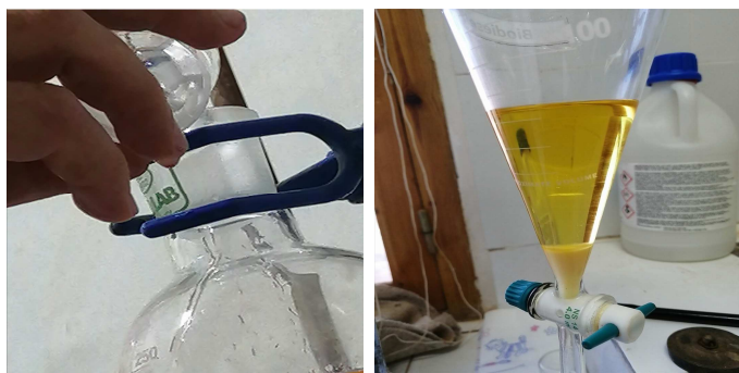
Figure25: Lavage du biodiesel
