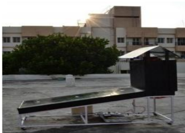
Figure III.6: Séchoir solaire en mode direct à convection forcée [7].
