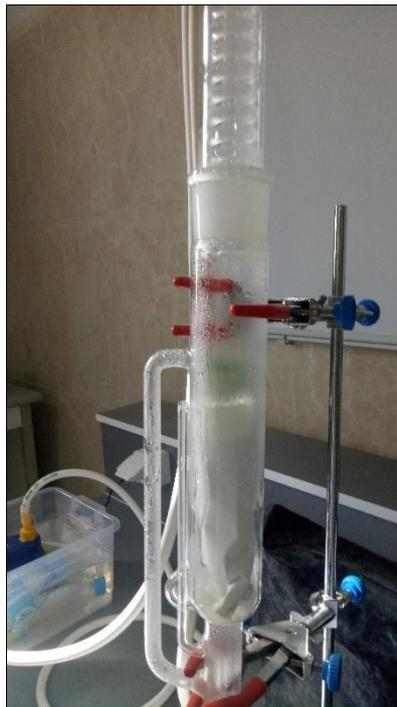
**Figure.13** Dispositif expérimental de l'extracteur Soxhlet.
