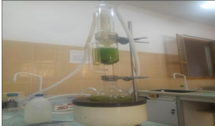
**Photo 03**: Extraction des polyphénols des feuilles de *Moringa oleifera* par appareil SOXHLET.
