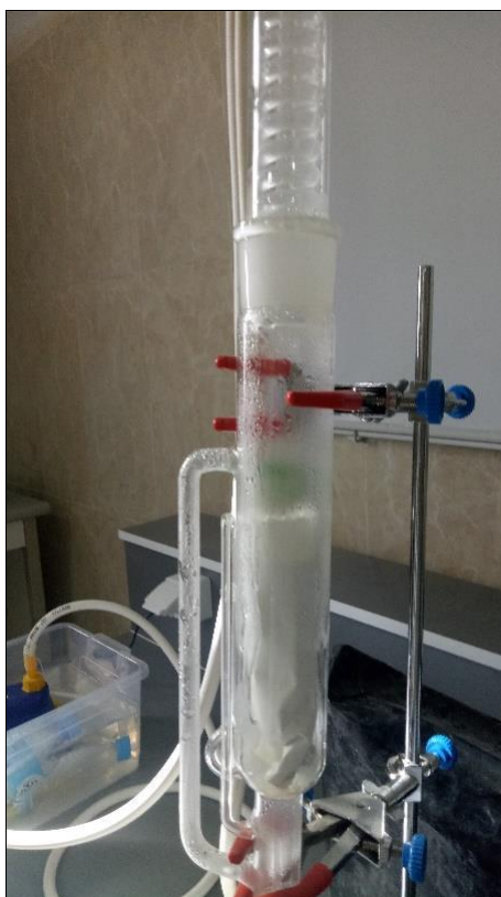
Figure.7: Dispositif expérimental de l'extracteur Soxhlet.
