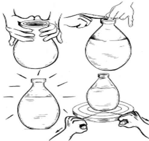
Figure II.4 : Le processus de modification du fond et des parois du bloc d'argile.
