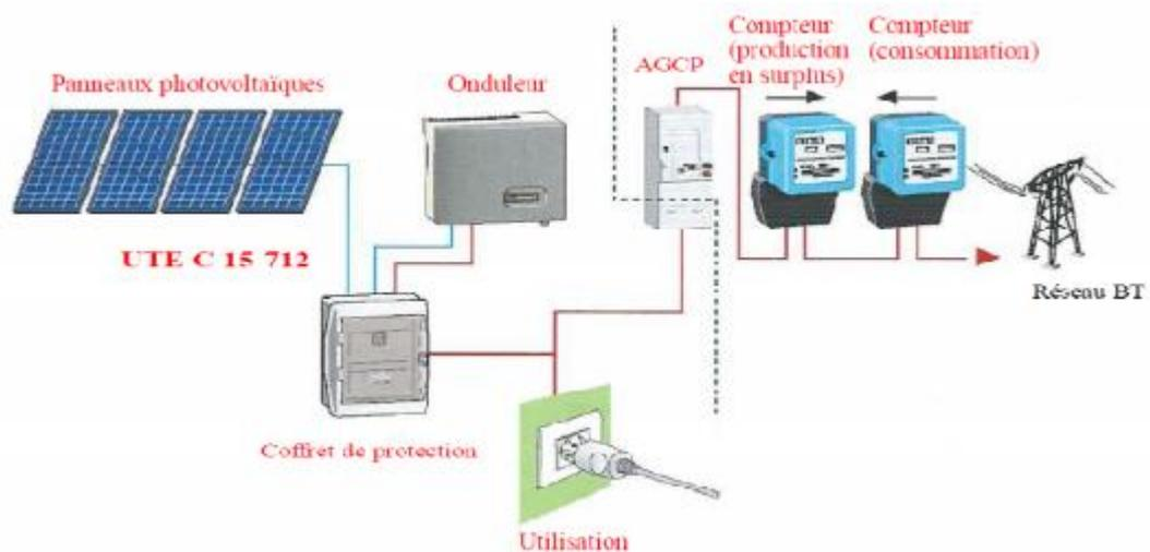
**Figure I-19:** Installation avec injection du surplus de la production photovoltaïque.
