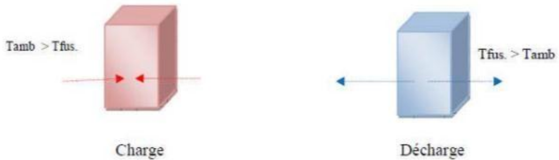
Figure II.10. Stockage et le déstockage de chaleur latente. [20]
