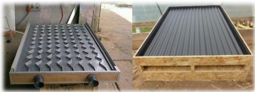
Figure III.11. Capteur à air avec les obstacles (chicanes longitudinales). [17]
