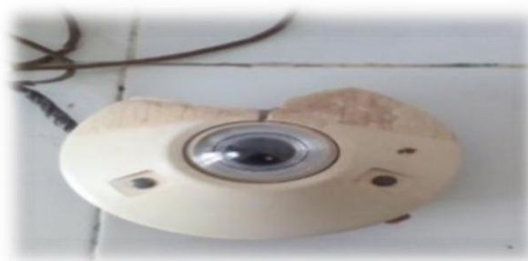
Figure IV.4. Le Pyranomètre mesurant le rayonnement solaire
