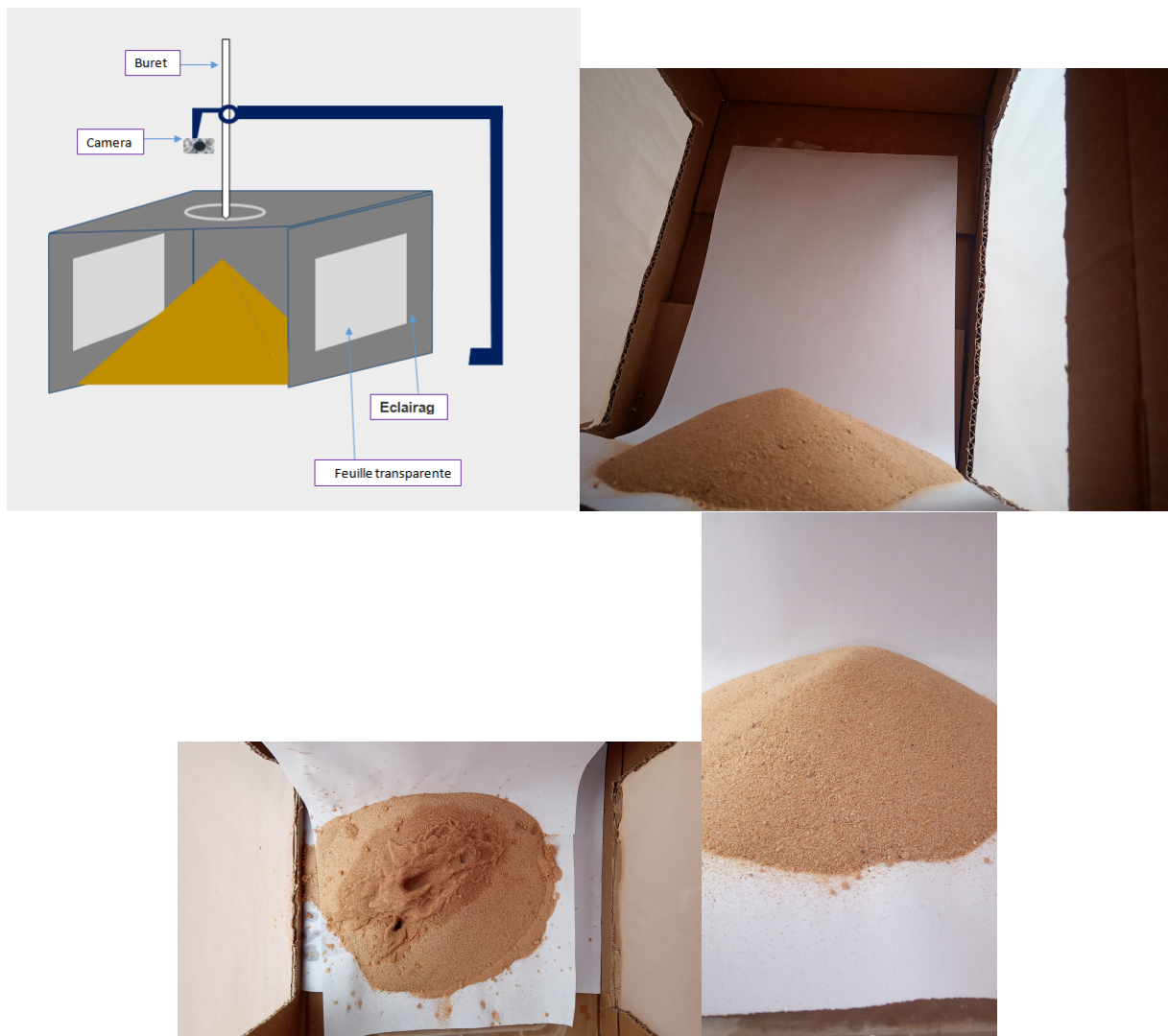
Figure 2.4: Prise de vue des éléments du banc d'essai
