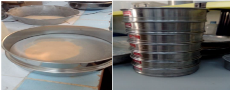
Figure 2.3: Photos représentant les tamis utilisés dans l'expérience
