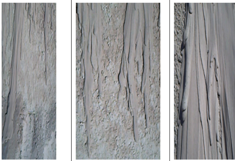
Figure 3.20: Vue instantanée d'un cycle de repli de la couche extérieure d'un tas de sable
