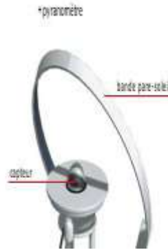
Figure I.9. Pyranomètre muni d'un cache [6]
