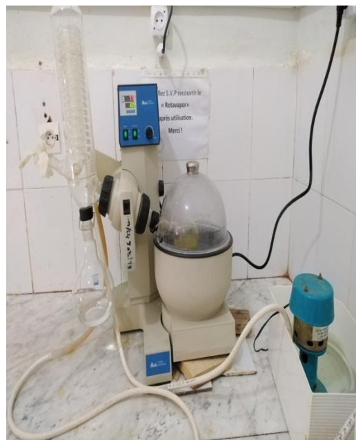
Photo III.5: Séparation de l'huile par le Rotavapeur.
