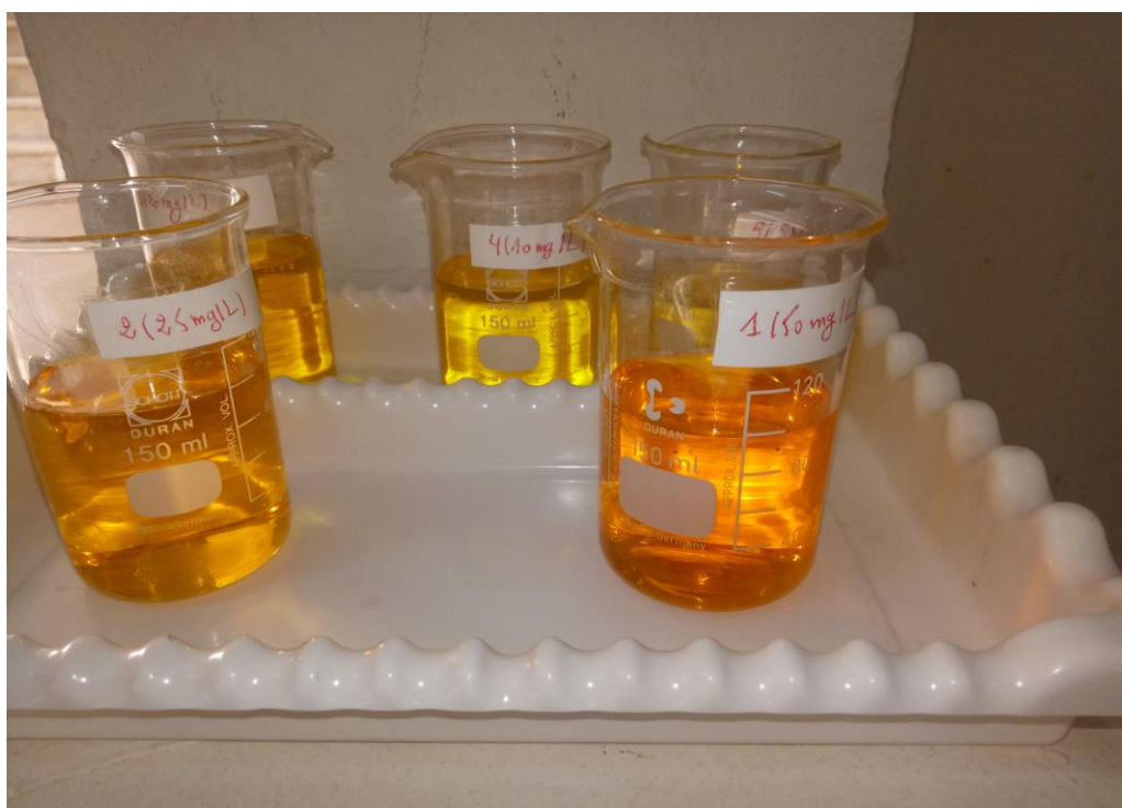
Figure 29: Les solutions de méthyle orange des concentrations 50mg/l, 25mg/l, 20mg/l, 10mg/l, 5mg/l.
