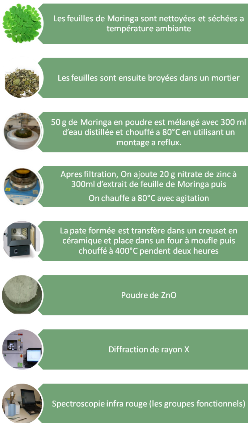
Figure 21: les étapes de la synthèse de nanoparticules de ZnO en utilisant l'extrait des feuilles de Moringaoleifera
