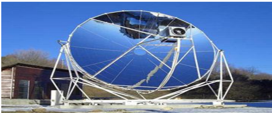
Figure I.14: les capteurs paraboliques
