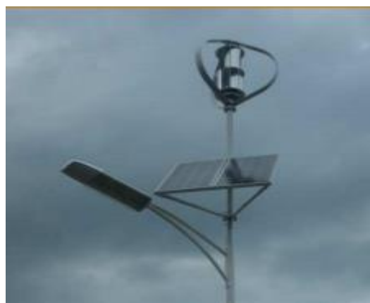
Figure III.32: lampadaires hybrides utilisant les énergies éolienne et solaire
