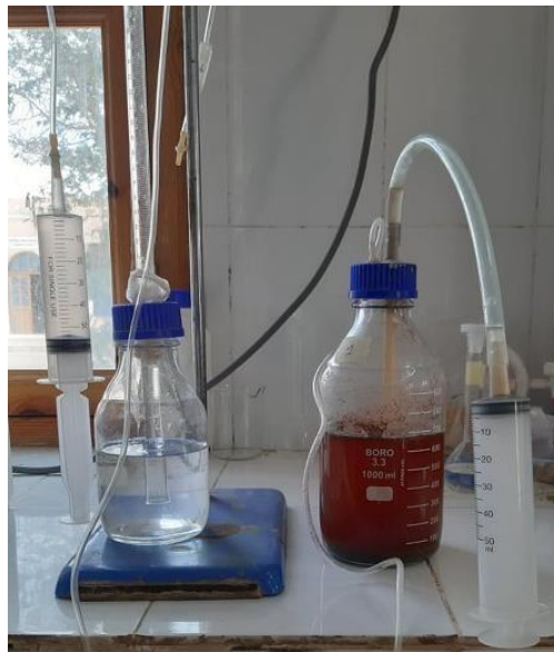
Figure III.5. Mesure de volume de biogaz
