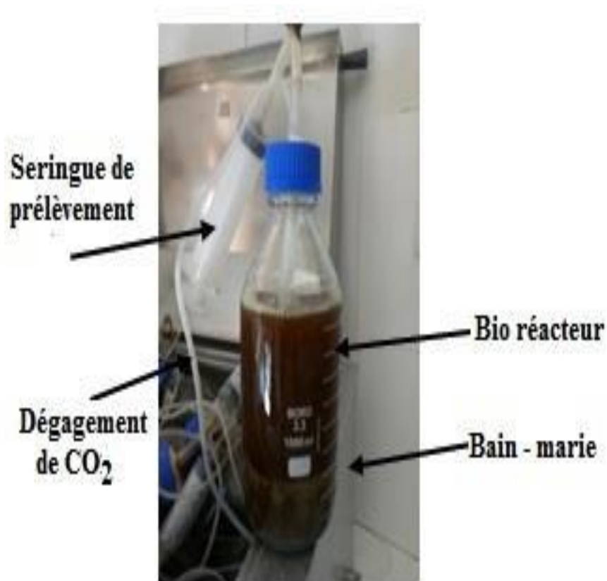
Figure 28 : Dispositif expérimental de la fermentation alcoolique.
