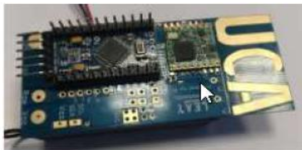
Figure I.25 : Module émetteur-récepteur LoRa (UCA_Board).
