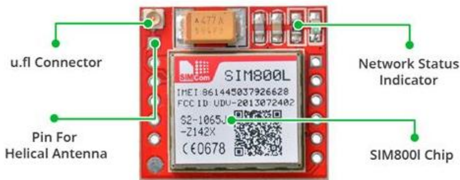
Figure II.12 : Présentation matérielle du module SIM800L GSM / GPRS.
