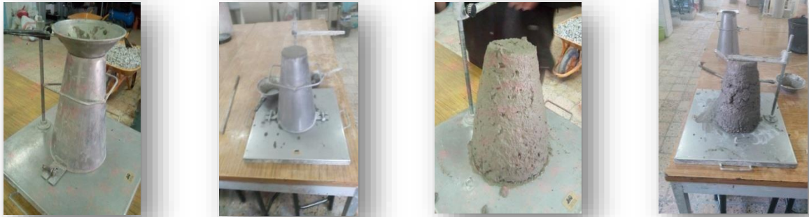
Photo3. 5Essai de cône d'ABRAMS[5]
