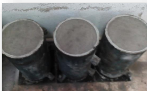
Photo3. 9 La conservation des éprouvettes avant démoulage[5]
