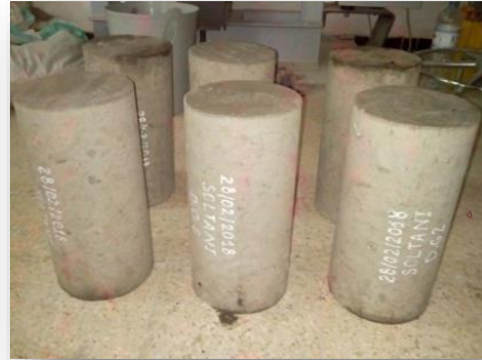
Photo3. 10Le démoulage des éprouvettes[5]
