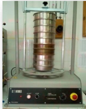
Photo3. 2Tamisage par une tamiseuse électrique[5]
