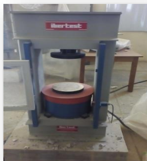
Photo3. 12 Machine d'essai de la compression[5]
