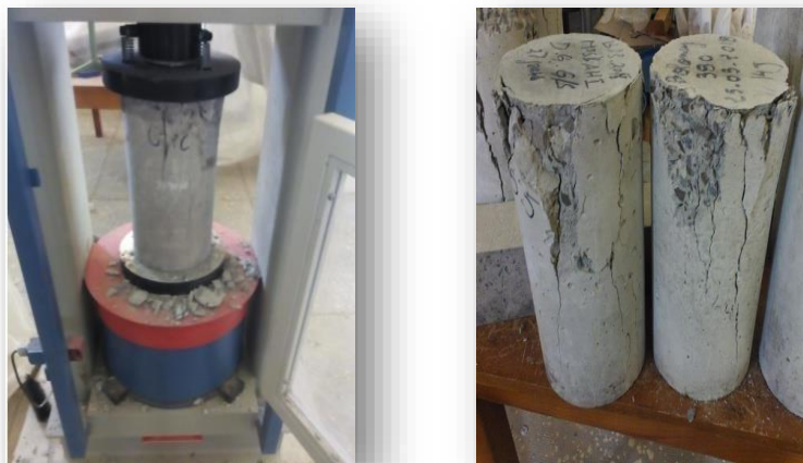
Photo3. 14 La rupture de l'éprouvette[5]
