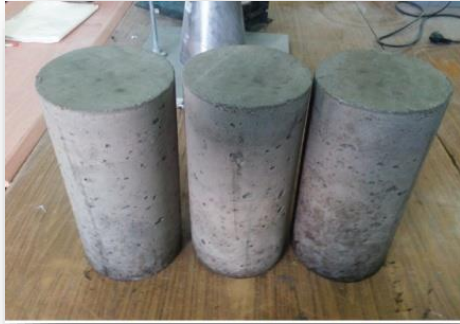
Photo3. 10Le démoulage des éprouvettes[5]
