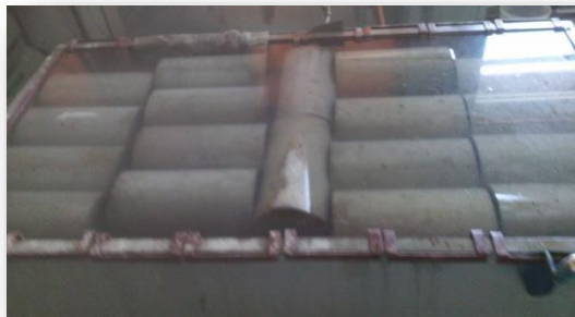
Photo3. 10Le démoulage des éprouvettes[5]
