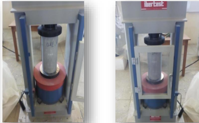
Photo3. 13 La mise en place dans la machine[5]
