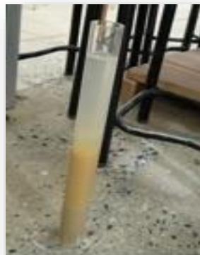
Photo3. 3 Essai équivalent de sable[5]
