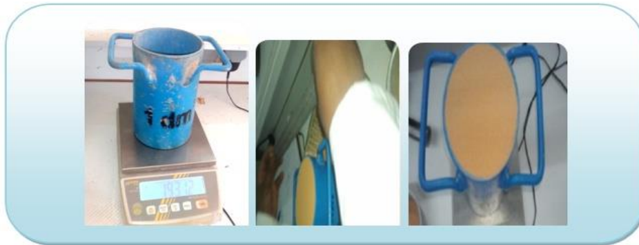
Photo II.12. Mode opératoire de l'essai de la masse volumique apparente.
