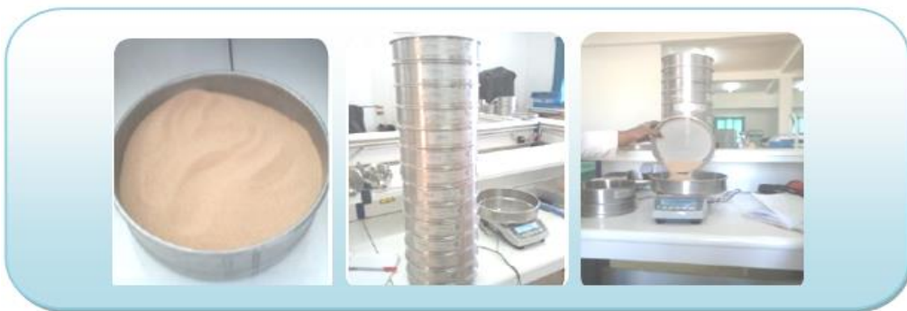
Photo II.10. Mode opératoire et appareillage de l'analyse granulométrique.
