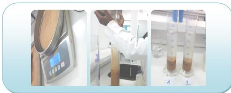
Photo II.13. Méthode de l'éprouvette graduée (la masse volumique absolue).
