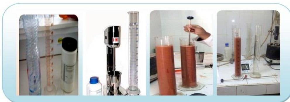
Photo II.4. Appareillage de l'analyse granulométrique par sédimentation.
