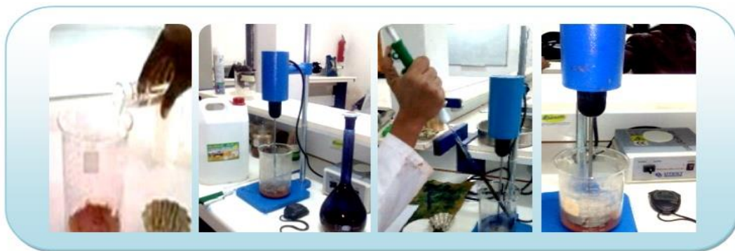
Photo II.7. L'appareillage de l'essai du bleu.
