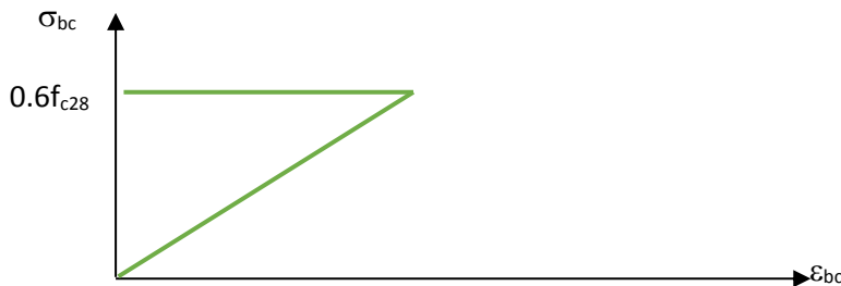
Figure I. 5 : Diagramme contraintes-déformations du béton à l'ELS.
