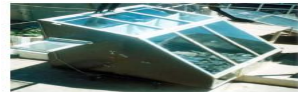
Figure I.8: Séchoir solaire direct en mode passif développée en C.D.E.R [9]
