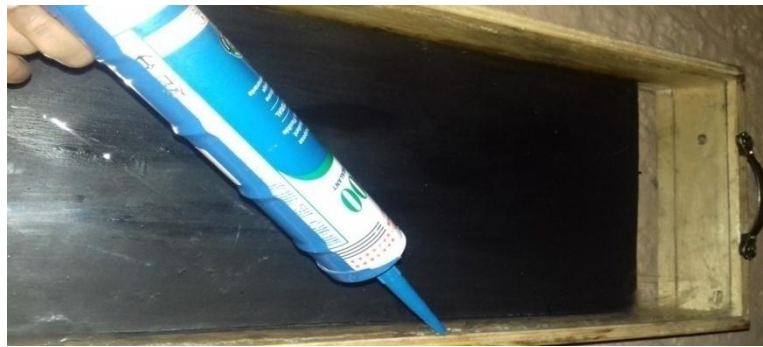
Figure IV.8: Collage des côtés du capteur
