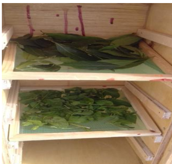
Figure V.5 : Les claies chargées par les produits à l'intérieur de la chambre de séchage.
