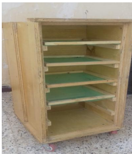
Figure IV.11 : La chambre du séchage
