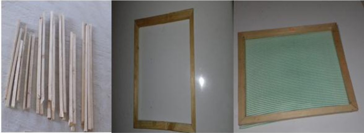
Figure IV.12: Fabrication des claies
