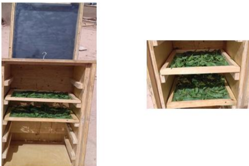
Figure V.22 : Les claires chargées par les produits à l'intérieur de l'enceinte de séchage.
