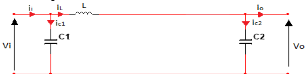
Figure (2. 4) : le schéma équivalent de convertisseur DC-DC de type BOOST l'interrupteur K est ouvert
